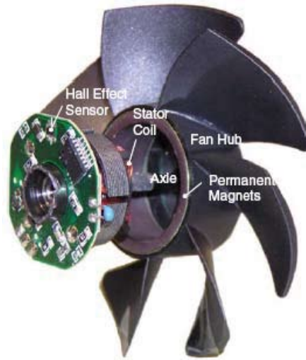
Construction of a BLDC fan
