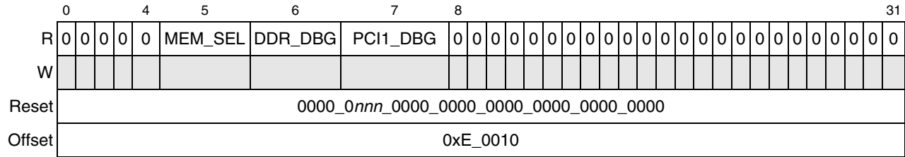
Figure 18-5. POR Debug Mode Status Register (PORDBGMSR)
