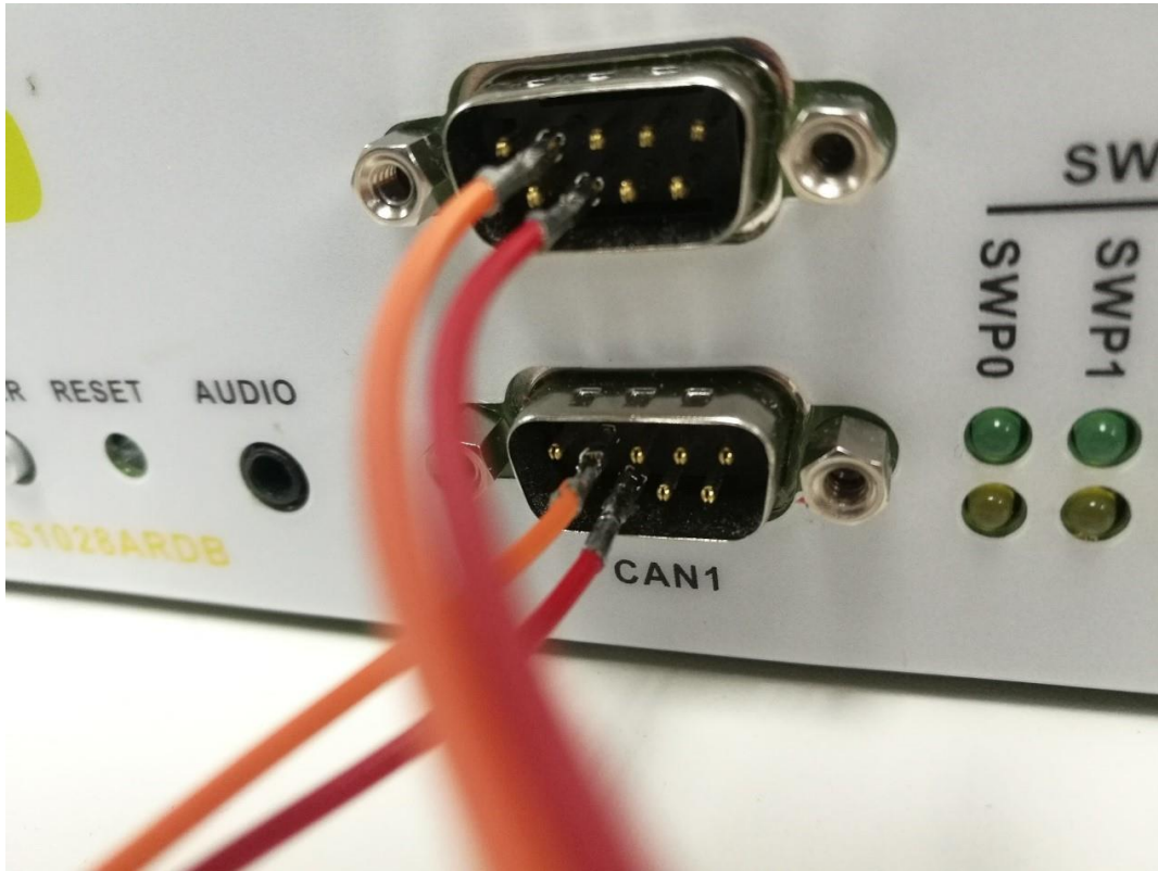
图 48.使用 LS1028ARDB 的 CAN 物理连接
