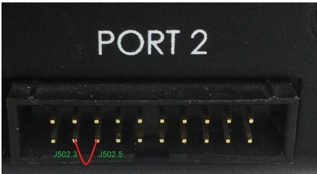
图 4.LS1021A-IoT 上的 GPIO24 和 GPIO25 连接
